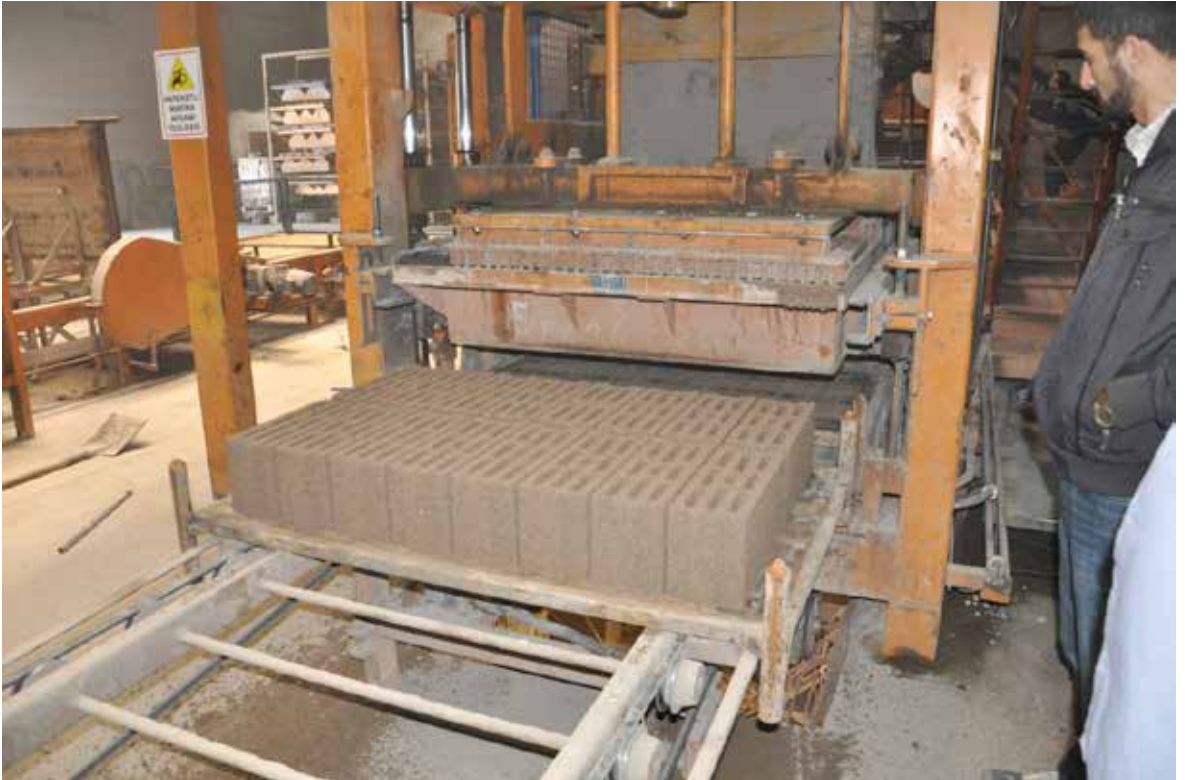
Şekil 2.20 Bimsblok üretiminden genel bir görünüm
