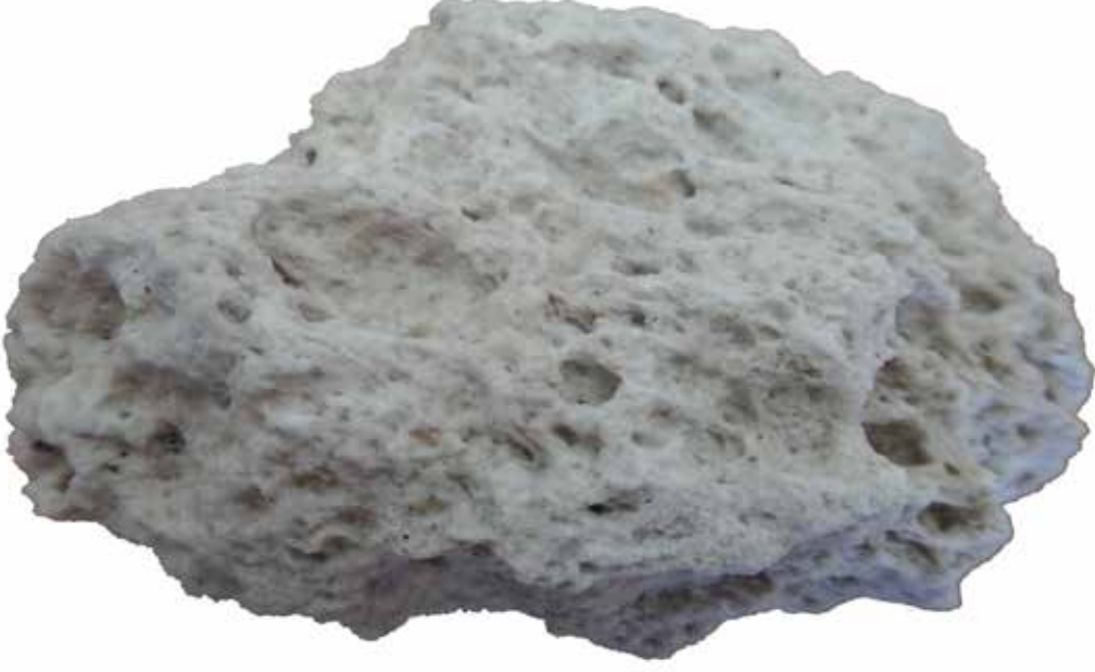
Şekil 2.1 Nevşehir pomzasının makro görünümü (örnek boyu 7.00 cm)
