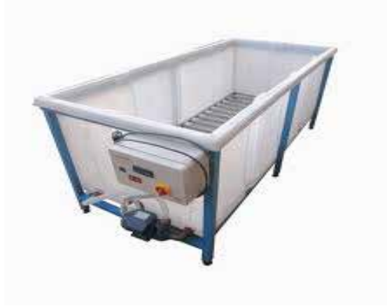
Şekil 4.7 Kür Havuzu (Tank) Cihazının Genel Görünümü.
